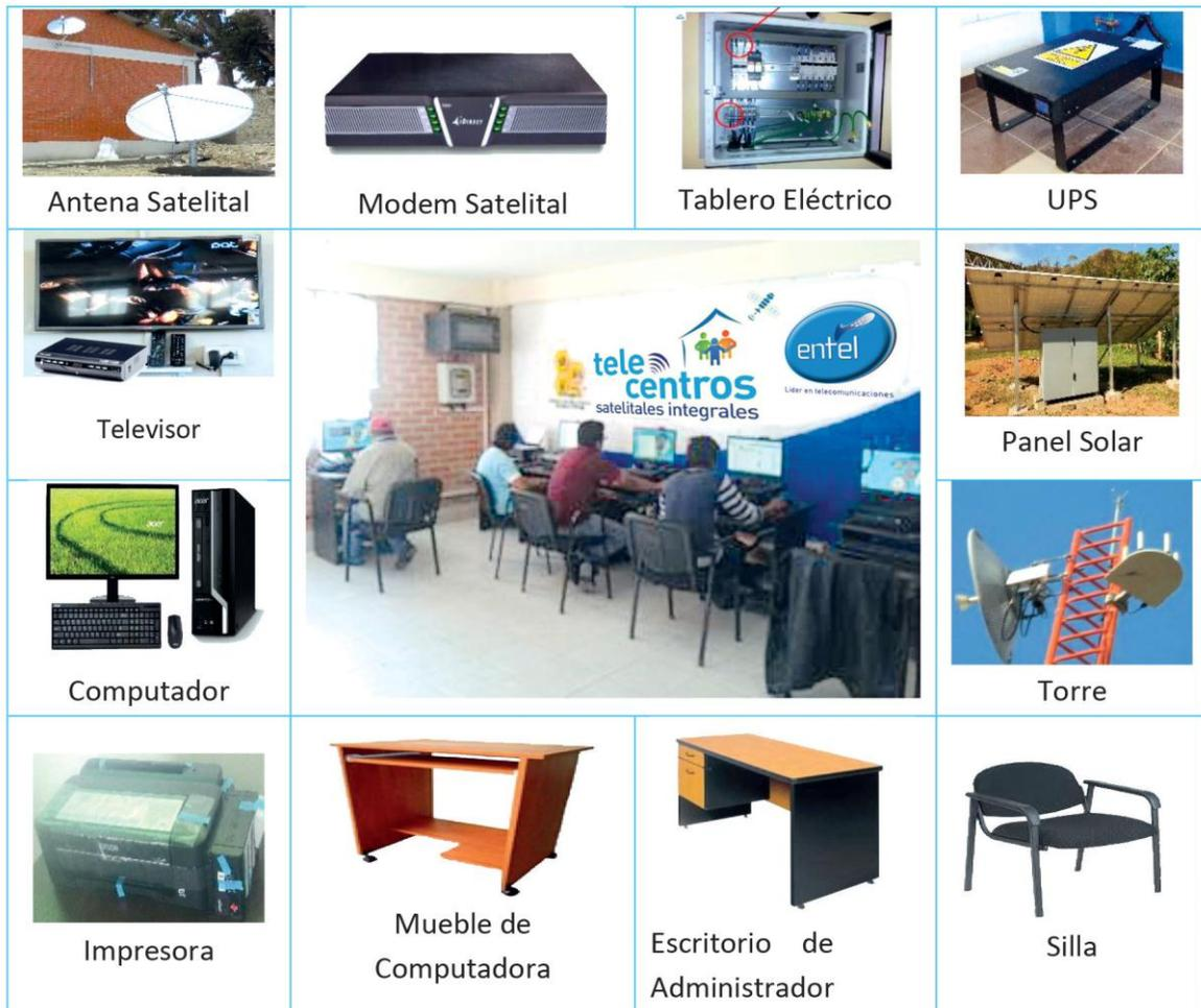
**Figura. Nro. 4.11.** Elementos que componen un Telecentro Satelital Integral. <sup>35</sup>
