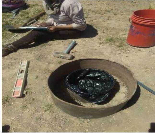
Figura 4. Prueba de infiltración
