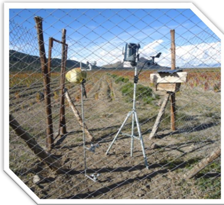
Figura 15. Estación meteorológica automática ubicada en medio del experimento de erosión eólica en la Estancia de Saytoco en el Municipio de Salinas de Garci Mendoza
