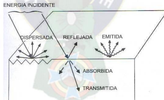
**Figura 4.** Formas de interacción de la radiación con la materia
