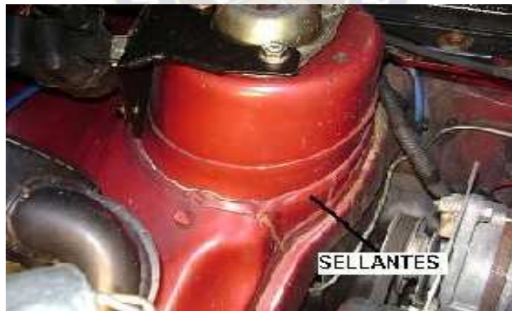
Figura: 4.9 unión entre piezas aplicado un sellante
