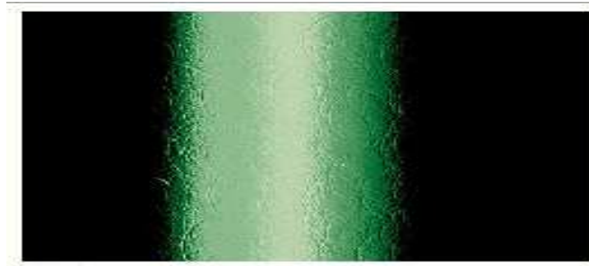
Figura. 4.29. Marcas de lijados en el pintado
