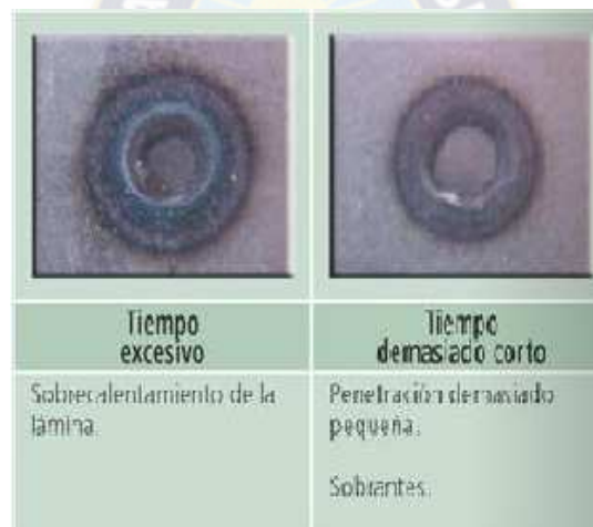
Figura. 4.17. Tiempo excesivo y demasiado corto de soldadura
