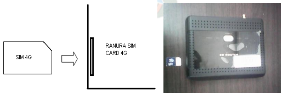
Figura N° 3-6 Instalación de la tarjeta SIM
