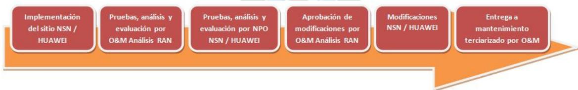
*Figura 37: Proceso de optimización de un sitio nuevo por áreas.*
