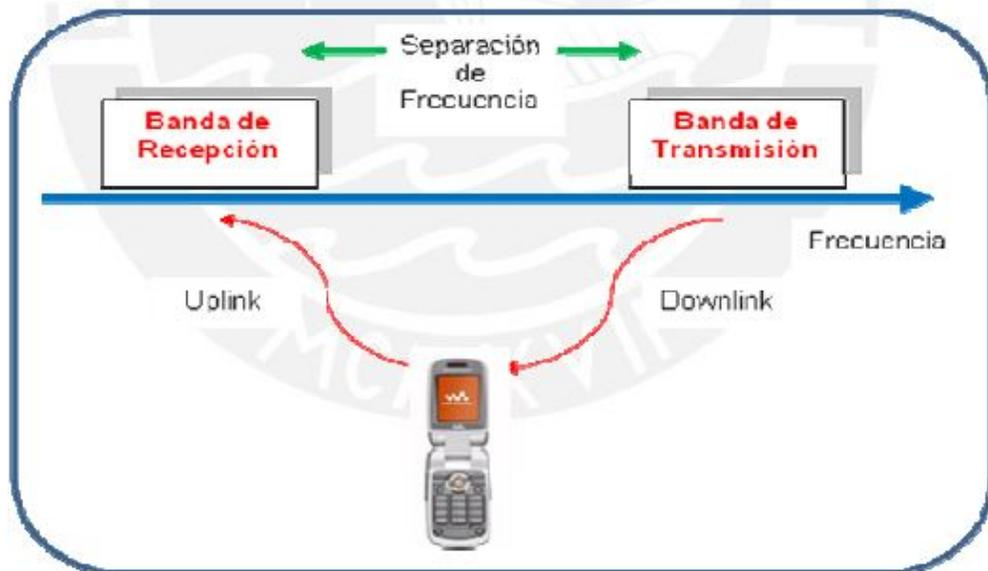
**Figura 3: Duplexaje FDD para una comunicación celular**
