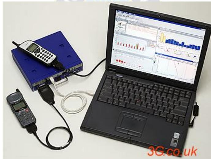
*Figura 12: Equipo para Drive Test Agilent.*
