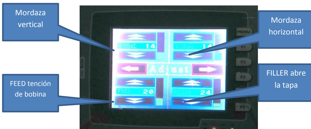
Fotografía 10.- PLC de Control de Parámetro de Sachet.
