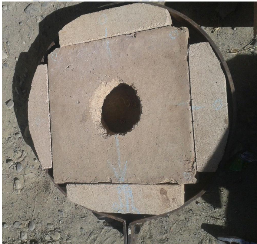
Fig. 27. Armado de la cubierta con los ladrillos refractarios
