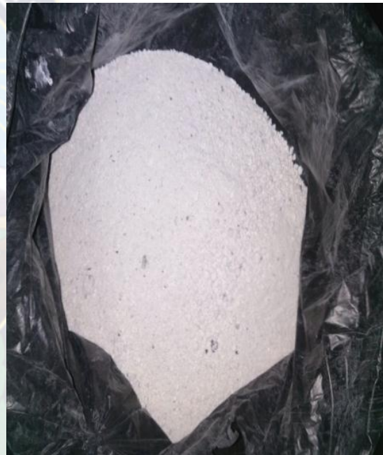
Fig. 25. Bauxita, ladrillo refractario molido
