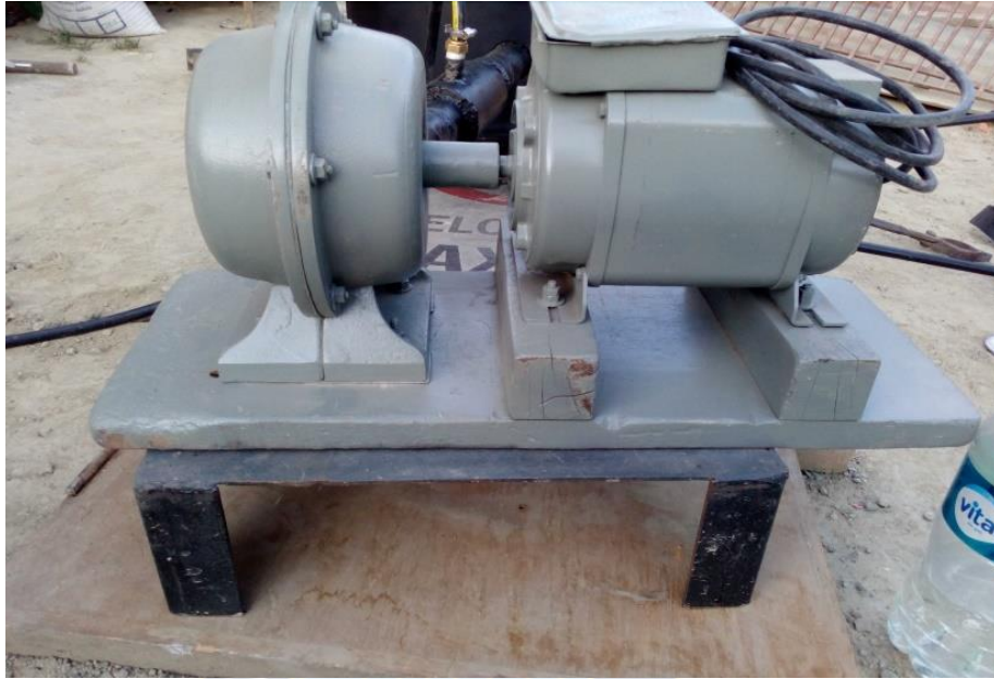
Fig. 31. Turbina conectado con su motor
