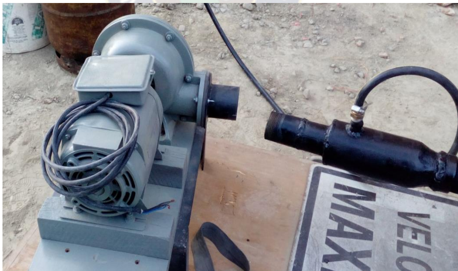
Fig. 29. Instalación de turbina o venterol con el quemador
