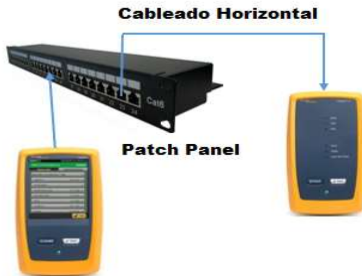
Figura: 39 Forma de Conexión para la certificación Fuente: Elaboración Propia
