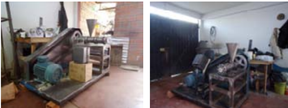
Figura 3.9. Elementos ensamblados del extrusor casi terminado.
