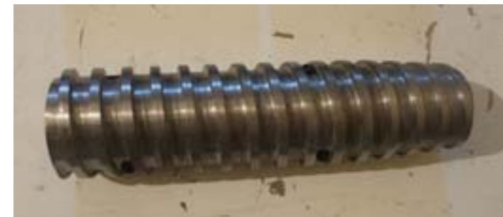
Figura 3.9. Tornillo de hilo simple sin mezclador.
