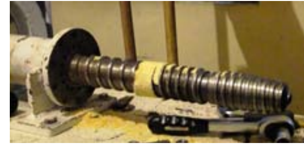
Figura 3.10. Tornillo de amasado de doble hilo y cocción de hilo simple.
