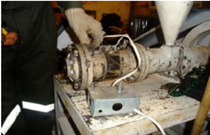
Figura 3.7. Sistema de calentamiento eléctrico de la camisa del extrusor.
