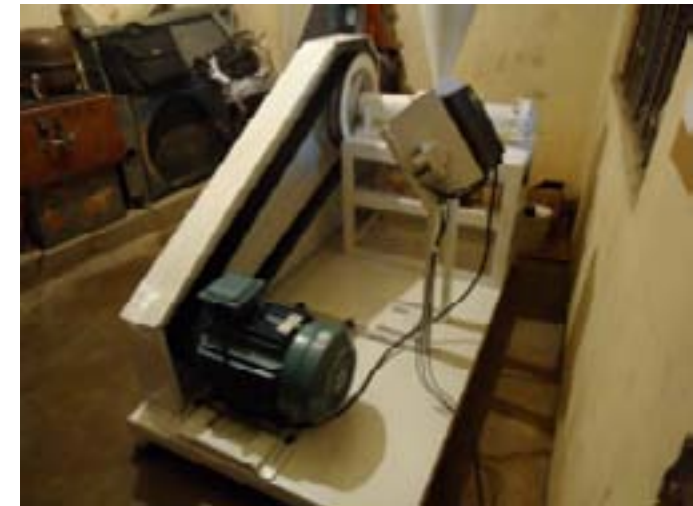
Figura 3.11. Extrusor para quinua terminado con el sistema eléctrico instalado.
