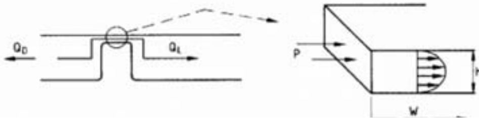
Figura 2.5 Representación del flujo de fuga.
