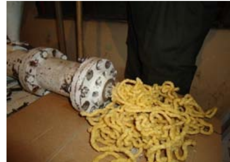
Figura 3.6. Extrusor con matriz de tres salidas de 3mm.
