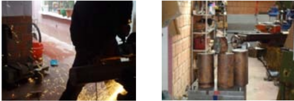
Figura 3.7. Cortando cilindro con amoladora y cilindros para camisas.
