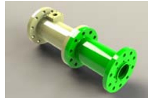
Figura 2.8. Camisas del tornillo de extrusión y sección de las camisas.
