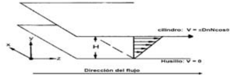
Figura 2.3. Perfil del flujo del material fundido en el extrusor.
