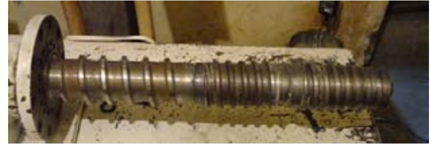
Figura 3.8. Tornillo de amasado y cocción de doble hilo.
