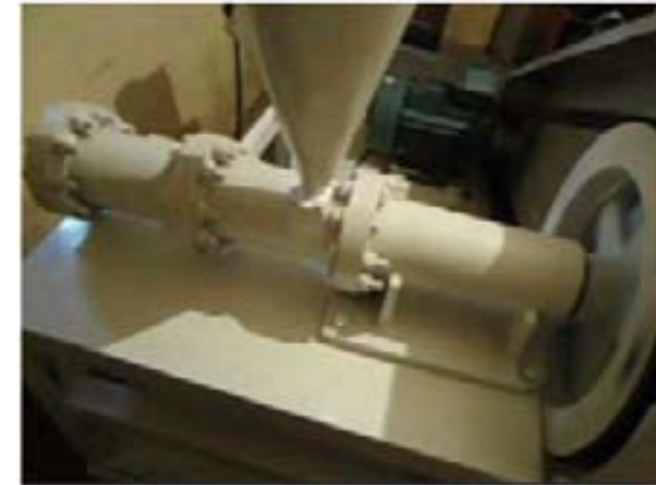
Figura3.4. Tornillo simple de extrusión con su camisa de alimentación y camisa de amasado y su troquel armado.
