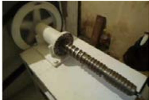
Figura 3.2. Tornillo simple y la camisa de alimentación.
