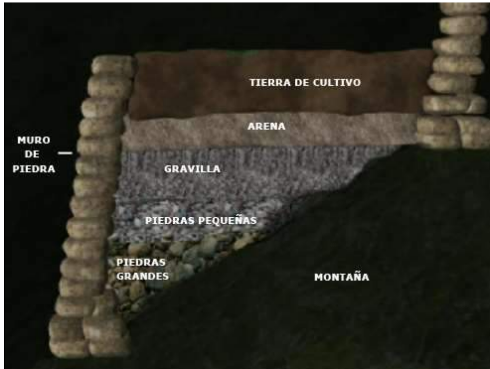
Figura 9. Relleno de las terrazas
