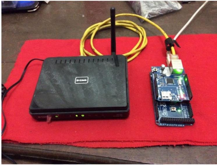
**Figura 3.31:** Conexión Física del Servidor
