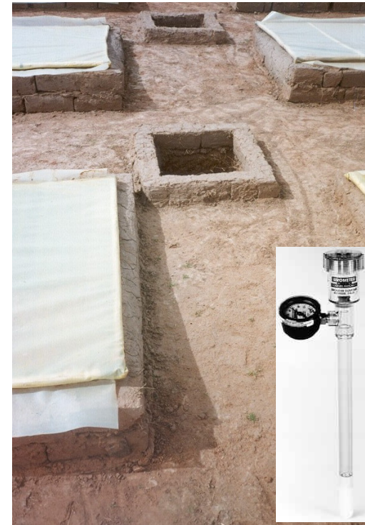
Cámaras de Drenaje (Lisímetros de Volumen)
