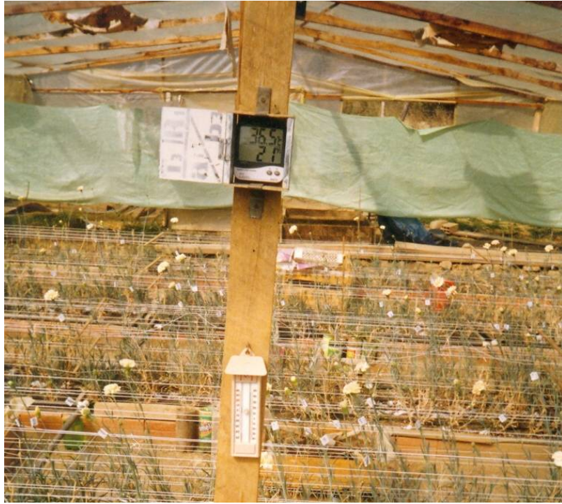
FOTO 11. Vista de termohigrómetro digital y termómetro “U”
