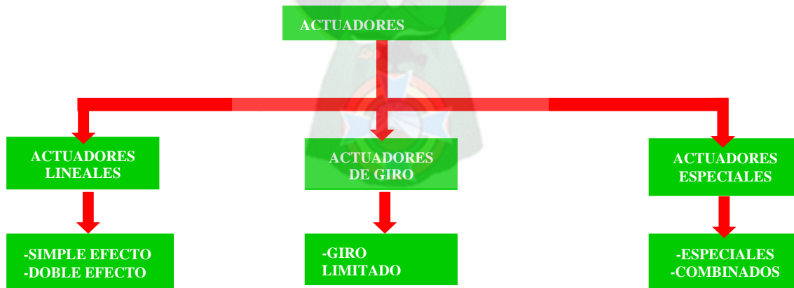
Figura 3. 26 Diagrama de clasificación de actuadores neumáticos
