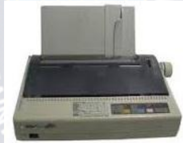
Fig. 3. 27 Impresora de matriz de puntos, marca Star®, modelo NX-1001, con puerto Centronics
