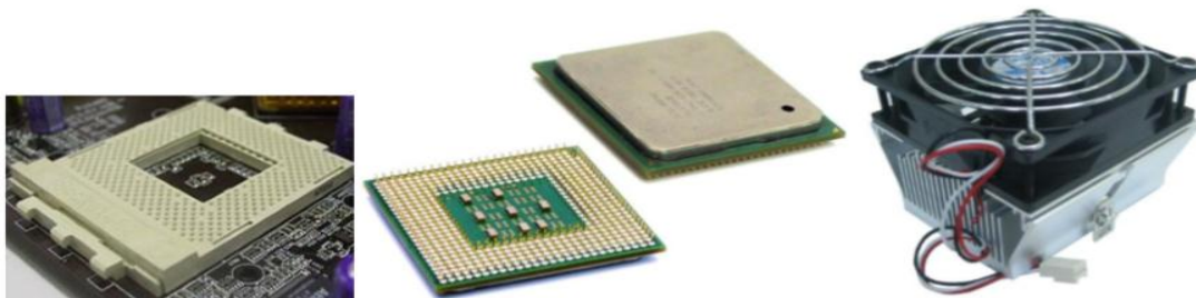
Fig. 3. 10 Microprocesador y su respectivo disipador
