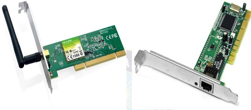
Fig. 3. 16 Tarjeta de red inalámbrica y con puerto Ethernet
