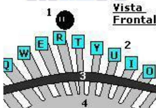
Fig. 3. 26 Esquema del mecanismo de impresión de una impresora de margarita
