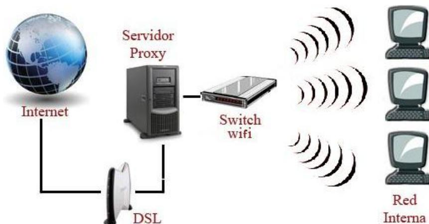
Figura 23 Red WLAN con servidor Proxy
