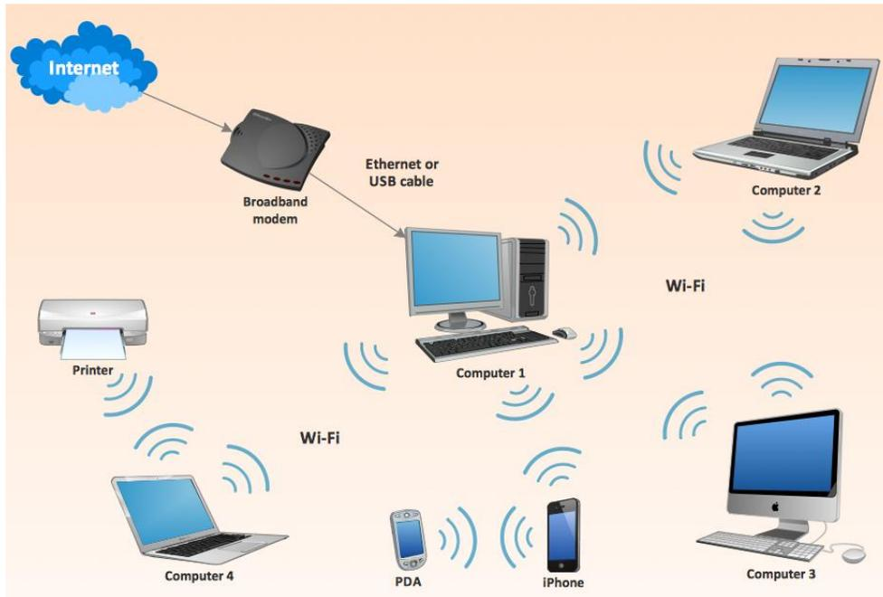
*Figura 9 Diagrama de una red Ad-Hoc*
