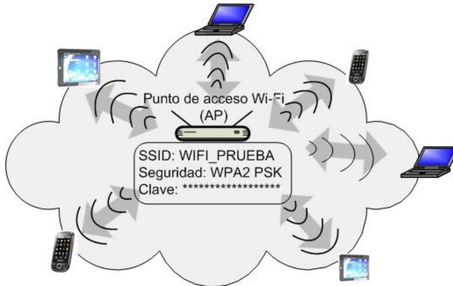
*Figura 10 Ejemplo de una red inalámbrica en modo infraestructura*
