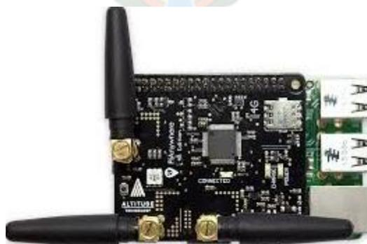
*Figura 29 Modulo 4G y GPS para Raspberry Pi
