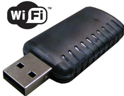
*Figura 22 Ejemplo de dongle USB a WiFi*
