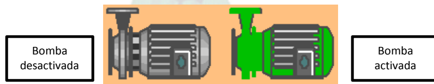
Figura 33-Monitoreo de estado de bomba
