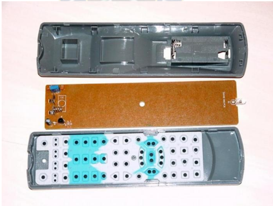
FIGURA 22 Control Remoto Desmontado 2 (fuente: http://tv.yoreparo.com )
