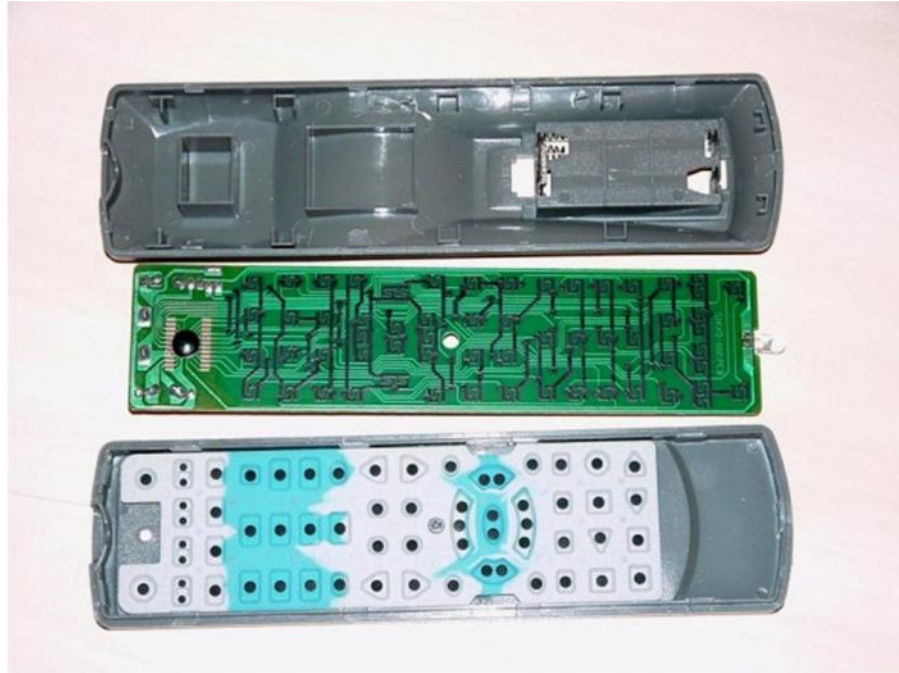
FIGURA 21 Control Remoto Desmontado 1 (fuente: http://tv.yoreparo.com )
