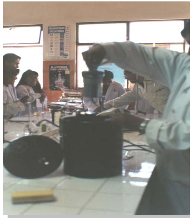
Fig. 21 Bomba calorimétrica, se introduce en su interior la cámara de combustión
