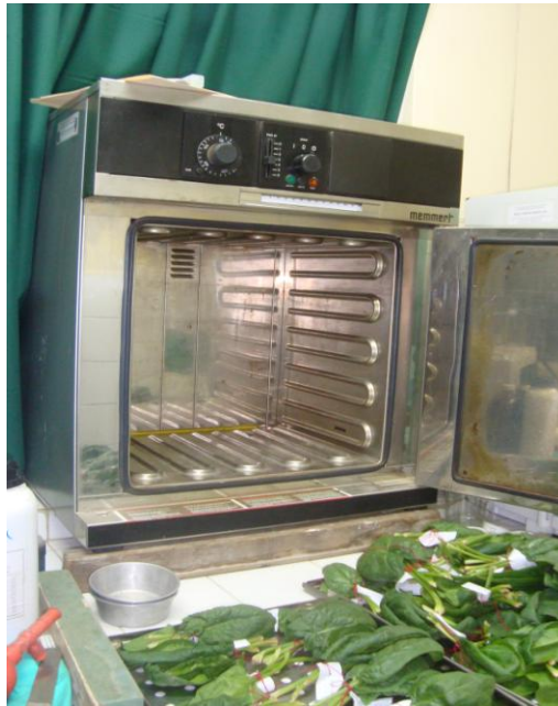
Fig. 11 Ingreso de las hojas a la estufa para poder determinar la cantidad de agua que tiene el cultivo de espinaca
