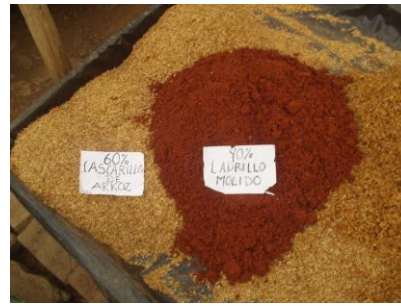
60% de cascarilla de arroz - 40% de ladrillo molido
