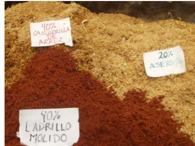
40% de ladrillo - 40 % cascarilla de arroz - 20 % de aserrín
