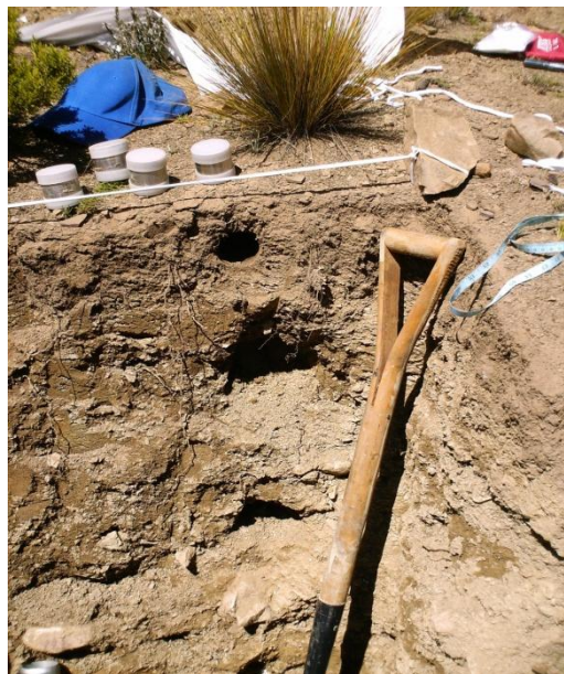
Fotografía 21. Apertura de calicata en la asociación vegetal tipo pajonal de sicuya
