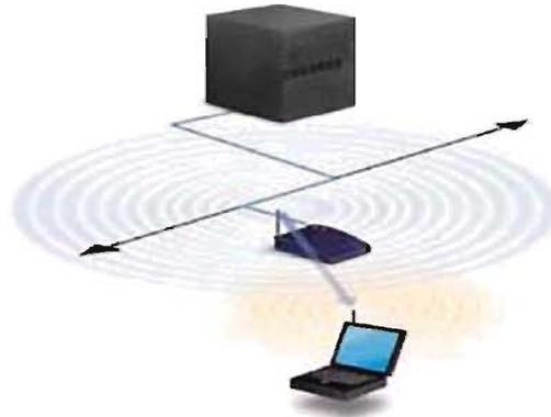
Figura 2.9 – Utilización de un Punto de acceso.
