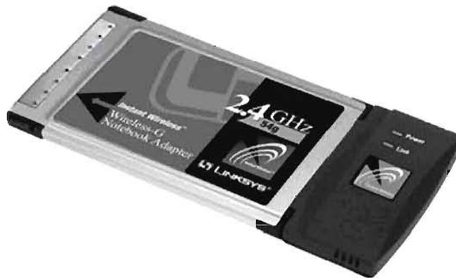
Fig. 2.13 Tarjeta de red PC-Card
