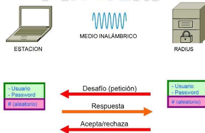
Figura 3.4. Representación del proceso de Autenticación y Autorización
