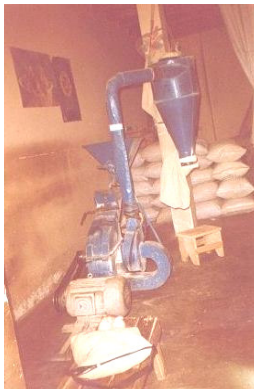
MOLINO ELECTRICO (Es el molino moderno para moler los granos). El molino de cereales de Doña Benita P., ubicada en la Plaza principal de Q'araqullu (Caracollo).
