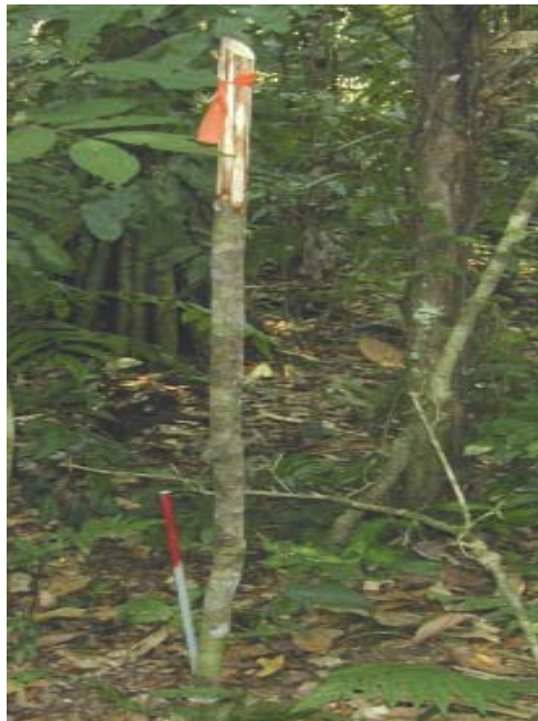
Figura 8. Jalón con cinta anaranjada y tubo PVC. Fuente: Proyecto Inventario Florístico de la Región Madidi (2005).
