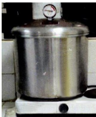
**Fig.15.- Material empleado como autoclave utilizado para el tratamiento térmico**
