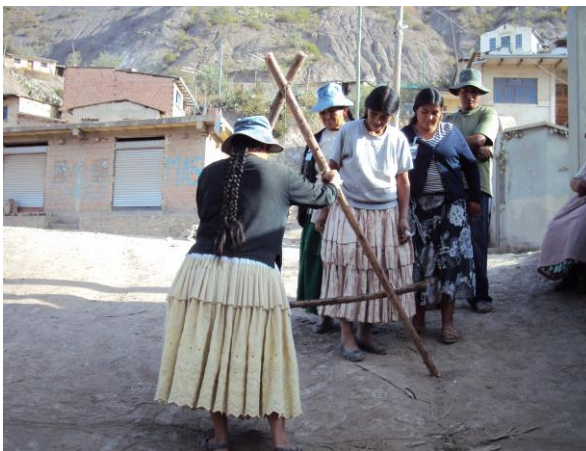
Figura 43: Uso del nivel en "A" en terrenos con pendientes y: La medición de las curvas de nivel al 1% y al 2%
