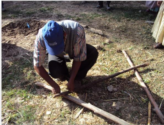
Figura 42: Construcción del nivel en "A" y la explicación para el uso del nivel en "A"
