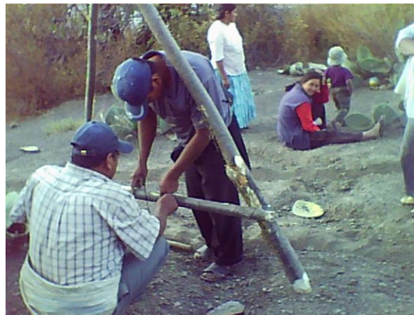
Figura 43: Uso del nivel en "A" en terrenos con pendientes y: La medición de las curvas de nivel al 1% y al 2%
