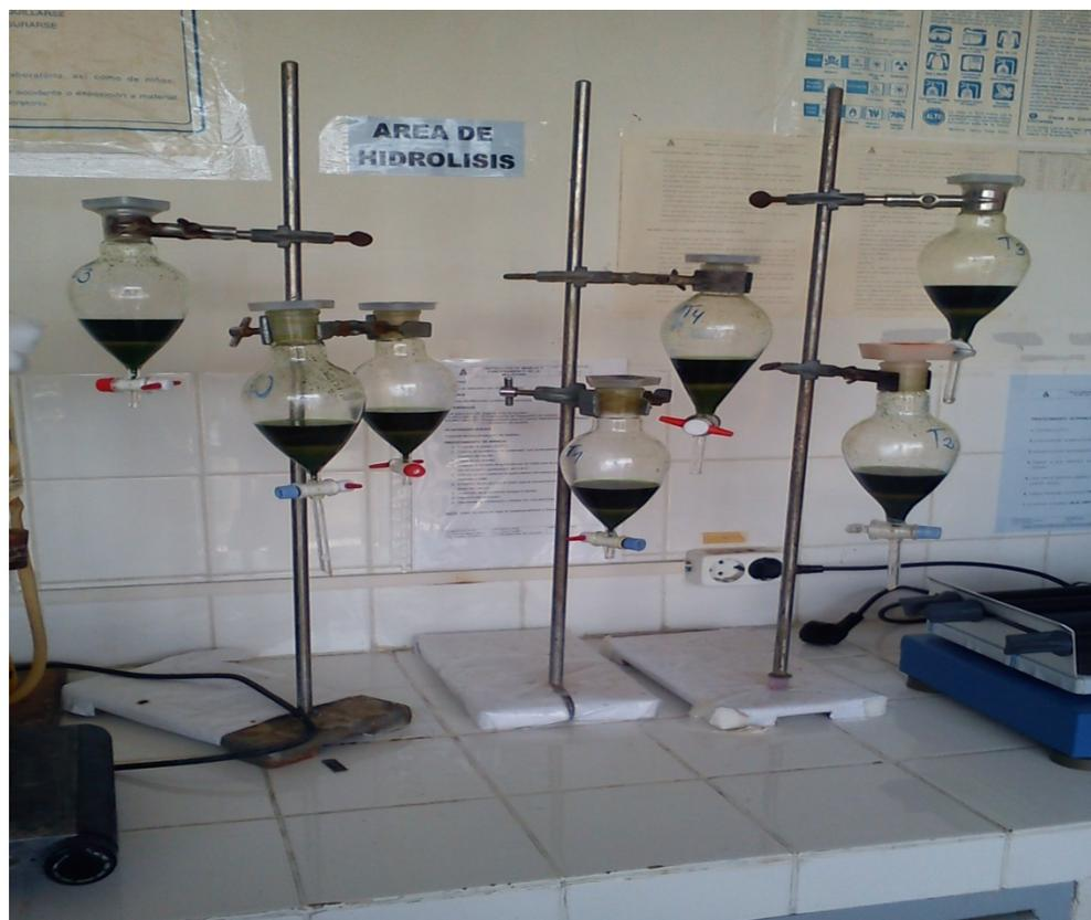
Fotografía 2. Extracción de las muestras por método de secado
