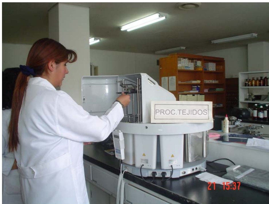
Figura N° 6: Procesador automático de tejidos
