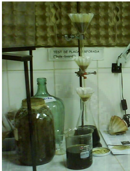
Proceso de filtración del extracto Fotografía tomada en el Instituto de Investigaciones Fármaco Bioquímicas
