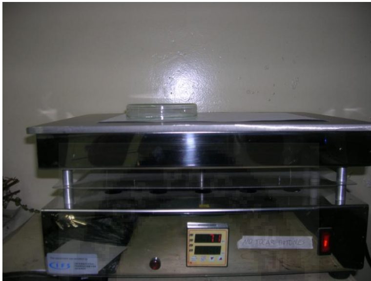
Fijación de las alas de las moscas con tratamiento en plancha caliente Modelo Quimix tomada en el Instituto de Investigaciones Fármaco Bioquímica en fecha 30 de mayo del 2009
