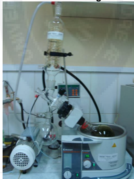
Proceso de rota vaporación del extracto etanólico de Piper elongatum Vahl Fotografía tomada en el Instituto de Investigaciones Fármaco Bioquímicas
