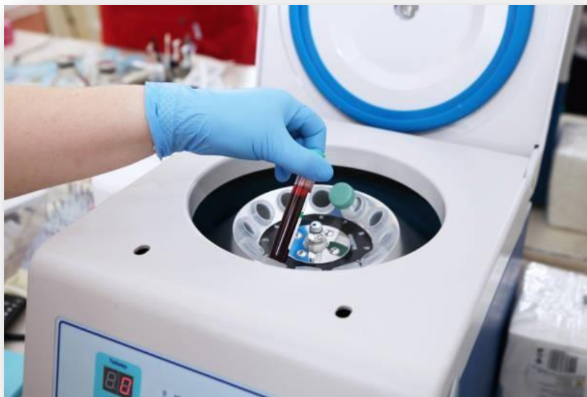
Figura 14. Centrifuga con rotor de ángulo fijo.
