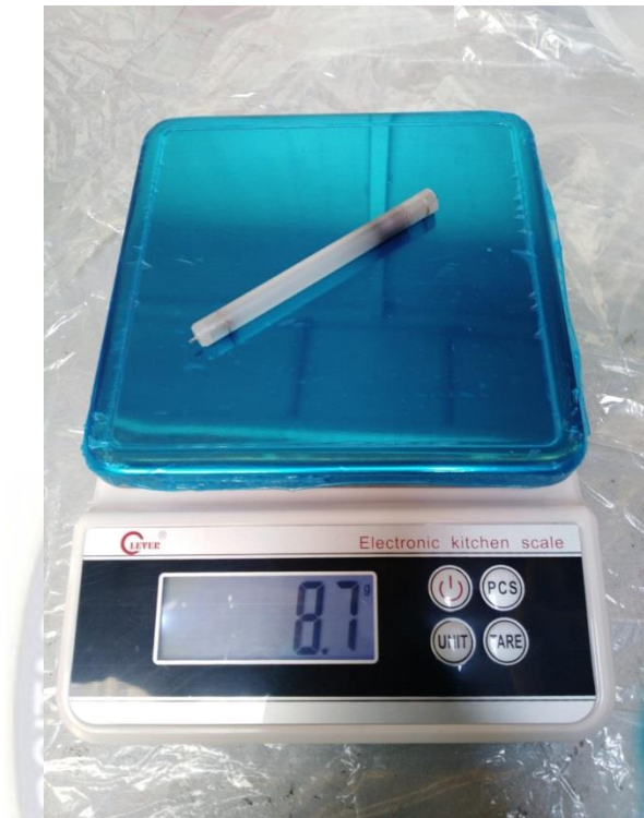
Figura 12. Tubo de descarga con contenido de mercurio con peso aproximado de 8.7 gramos
