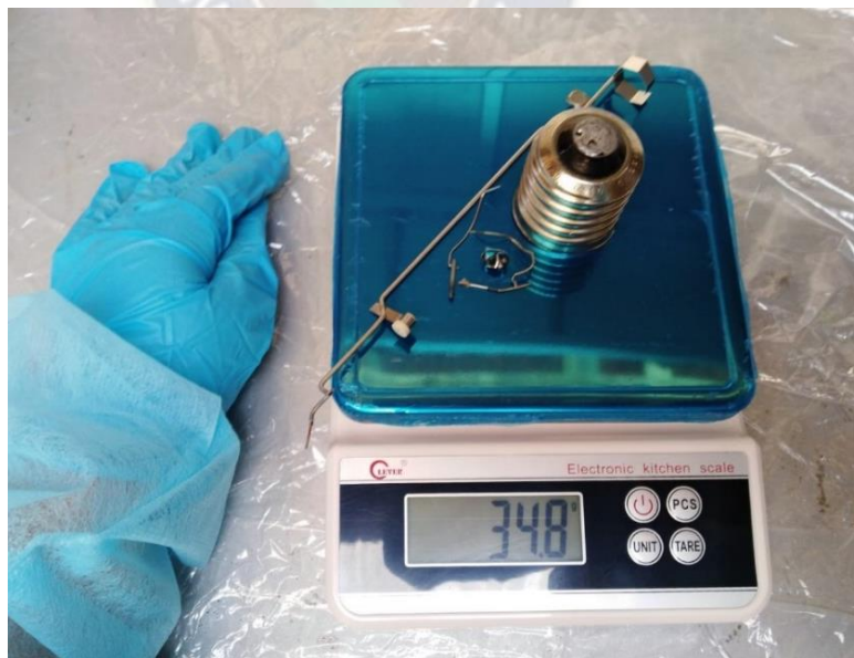
Figura 11. Casquillo y material ferroso de soporte con peso aproximado 34.8 gramos
