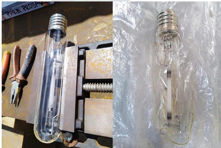
Figura 9. Quebrado del vidrio exterior con una prensa plana
