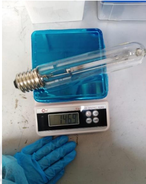
Figura 8. Lámpara de alumbrado público de 250w con un peso aproximado de 146.9 gramos.
