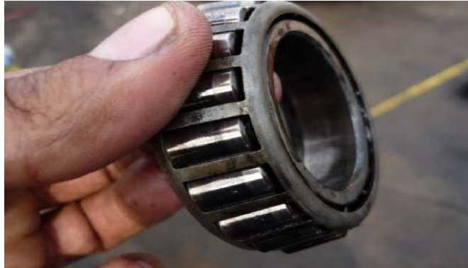
Figura N° 44 Rodamiento en mal estado.
