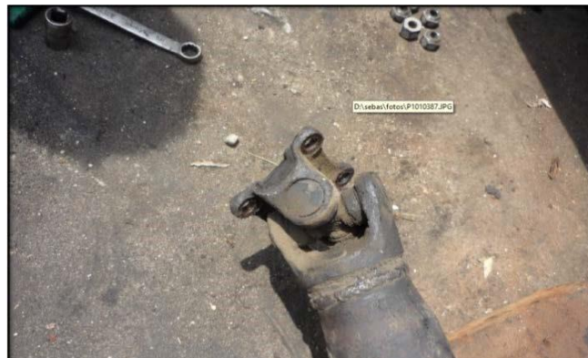
Figura N° 39 Desmontaje de la cruceta
