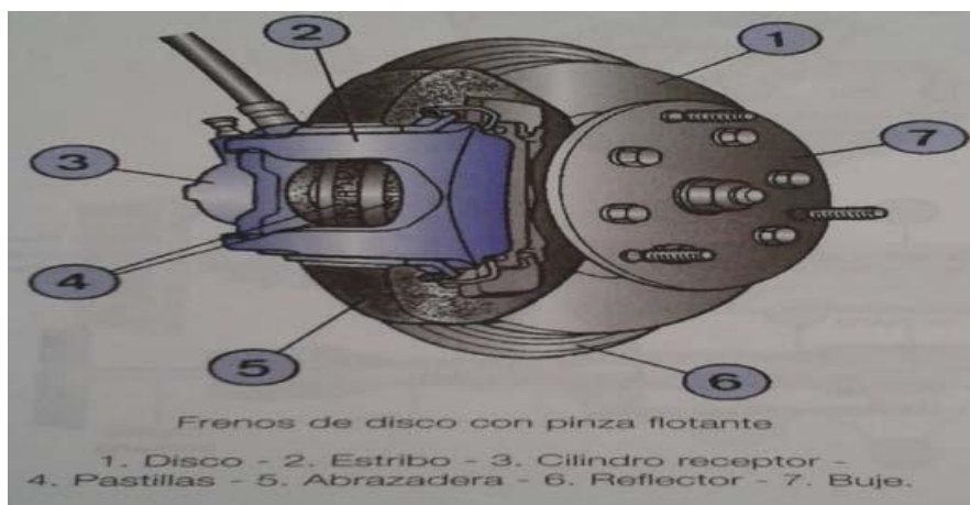
Figura N° 14 Esquema frenos de disco con pinza flotante
