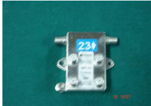
Figura 2.22: TAP interno, Atenuación por Salidas. Fuente: Silva, 2018
