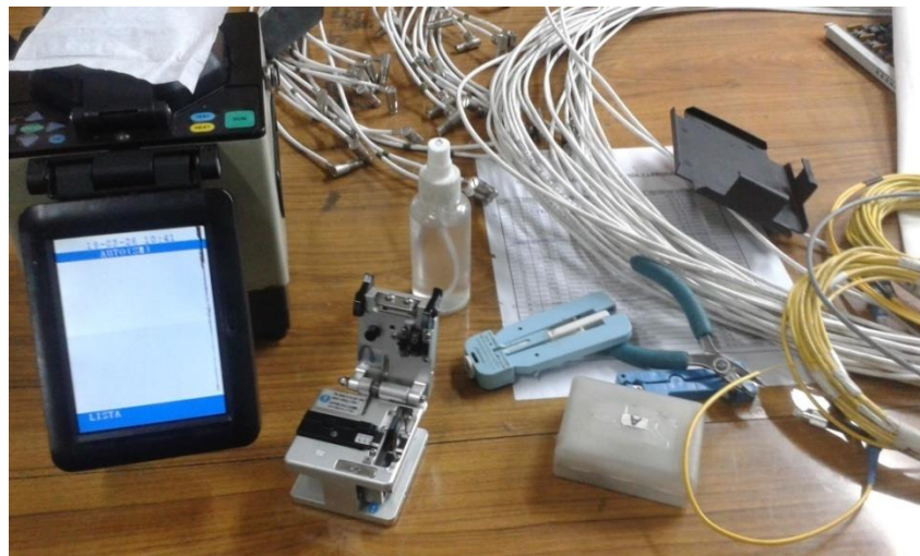
Figura 3.5: Herramientas de Fusión de Fibra Óptica. Fuente: Fotografía Propia
