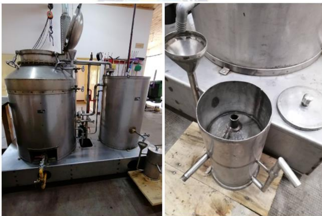
Figura 4.6 Mecanismo de separación de aceites esenciales
