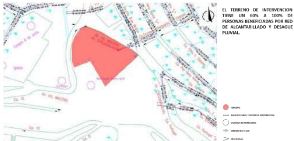
Ilustración 44. Alcantarillado y desagüe pluvial
