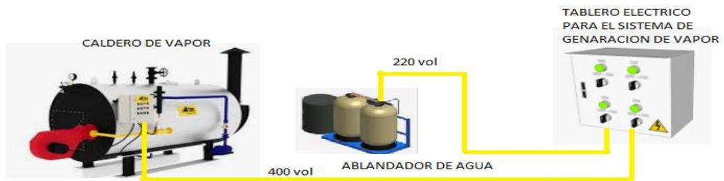
*Figura 30. Distribución eléctrica del sistema de generación de vapor
