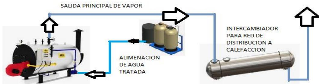
*Figura19. Distribución de vapor para el sistema de calefacción*
