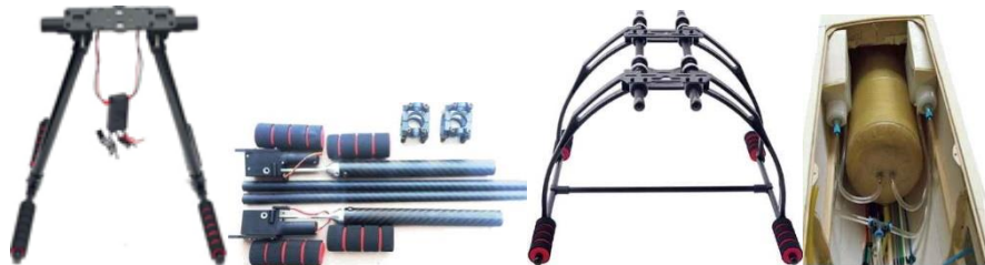
Figura 20. Principales elementos y conjunto del tren de aterrizaje de un dron.
