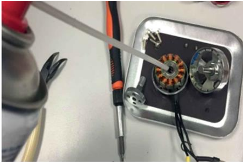
Figura 32. Desmontaje y limpieza de un motor.
