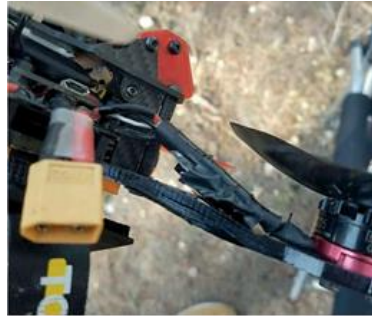
Figura 23. Chasis con la fibra agrietada tras el golpe
