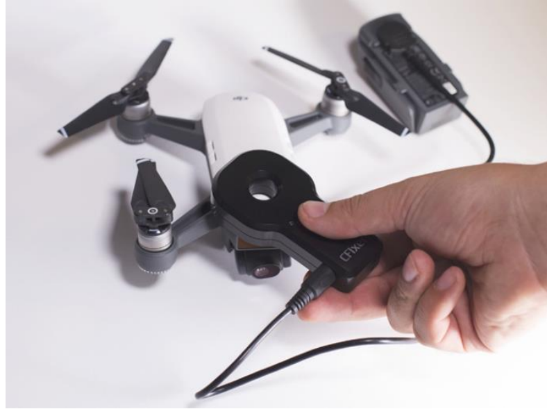
Des magnetización del dron debido a interferencias electromagnéticas
