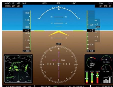
Figura 46. Representación sintética de la información de vuelo, motores y navegación. (Fuente: autoría propia)
