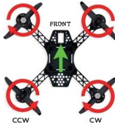
Figura 54. Sentido de giro correcto en un cuadricóptero. (Fuente: www.google.com )
