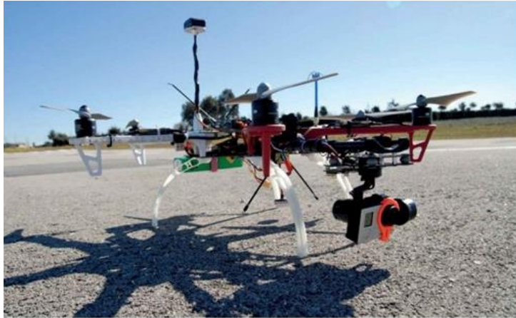
Figura 34. Hexacóptero equipado con un sistema autónomo de vuelo y gimbal de grabación. Fuente: www.google.com
