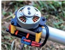
Figura 13. Conjunto bancada/motor montado en un dron.
