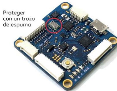
Figura 39. Capsula barométrica en una controladora F3.
