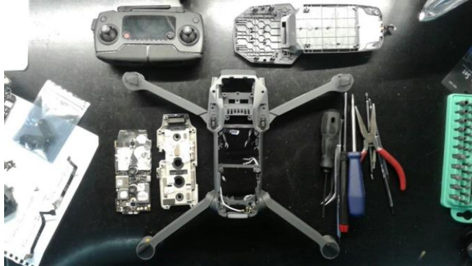
Figura 59. Ensamble y herramientas de reparación de drones.
