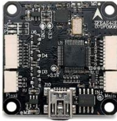
Figura 37. Flecha o indicador de dirección en una FC
