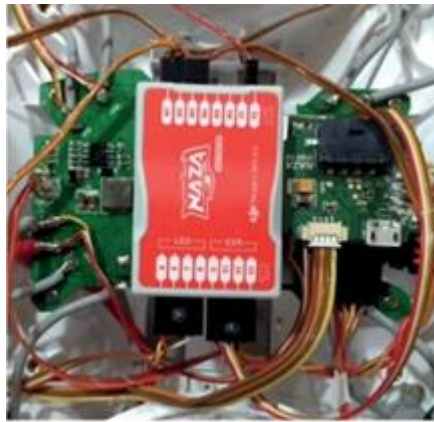
Figura 53. Cableado de una FC.
