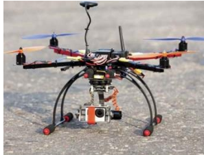
Figura 12. Disposición de antenas y gimbal en un dron multirrotor.
