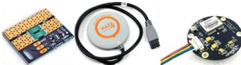
Figura 42. Sensores de corriente, unidad de GPS y Unidad GPS/magnetómetro abierta. (Fuente: www.google.com )
