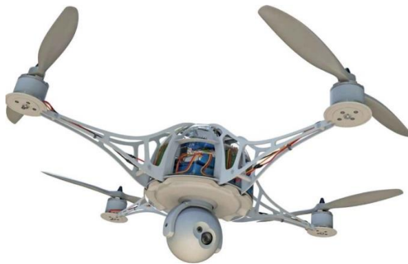
Figura 25. Cuerpo de un cuadricóptero con estructura de aluminio
