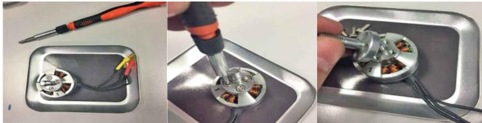
Figura 48. Secuencia de desmontaje de motor.
