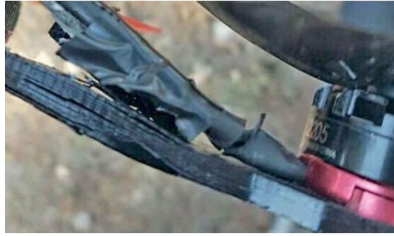
Figura 28. Des laminado de un brazo de fibra de carbono.
