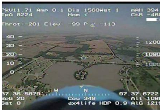
Figura 47. Representación sintética que muestra información de vuelo integrada. (Fuente: Propia)
