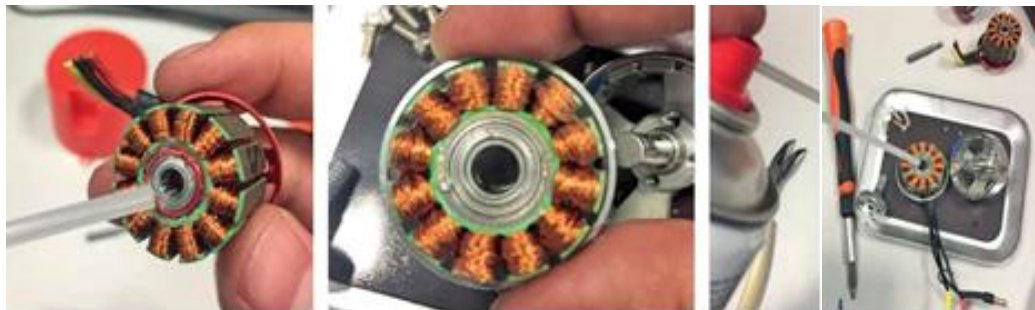
Figura 50. Soplado de las espiras del estator del motor, comprobación de los rodamientos del eje interior del estator y soplado del eje interior del estator del motor. (Fuente. Propia)
