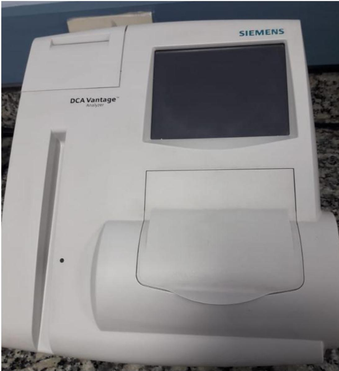
Fig. 4. El analizador DCA Vantage. Para determinar la HbA1c
