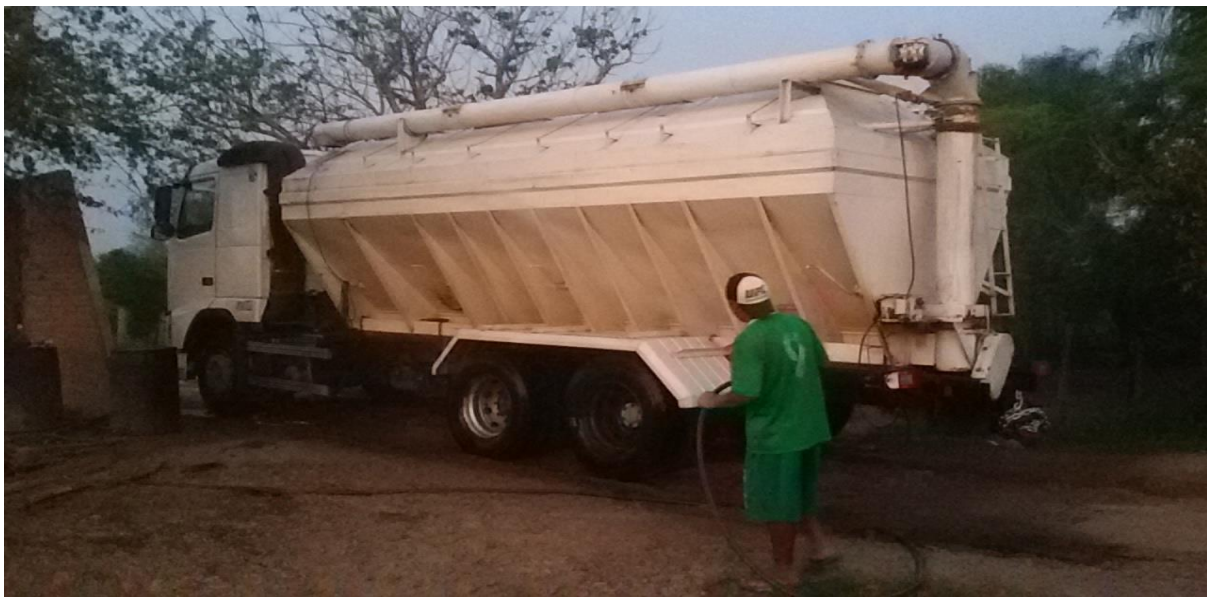
Camión granelero que descarga alimento directo al silo
