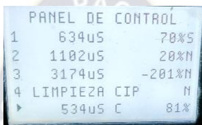
Figura 4.22 Interfaz HMI del sistema en modo marcha.
