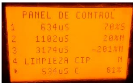
Figura 4.21 Interfaz HMI seleccionando la primera referencia en modo paro.
