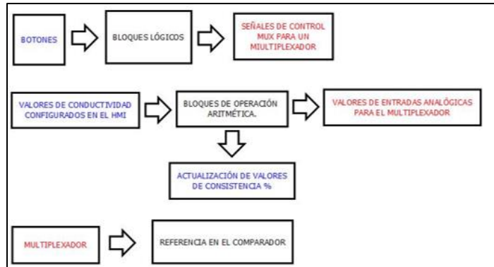
Figura 3.23 Pasos para relacionar el HMI y los bloques del algoritmo.
