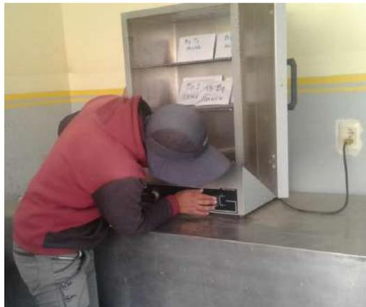
**Figura 18. Colocado de las muestras de materia verde en la mufla a 105°**
