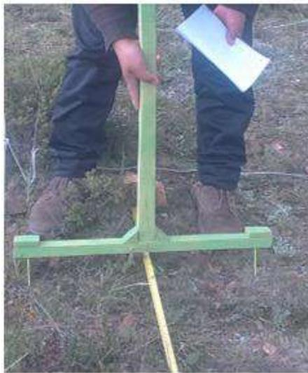
**Figura 12. Puntero con dos agujas para el muestreo simultáneo de dos puntos separados 50 cm entre si**
