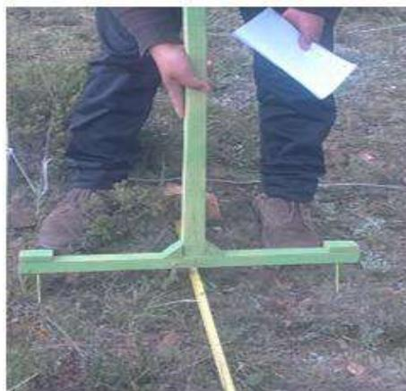
Puntero con dos agujas para el muestreo simultáneo de dos puntos separados  $50\text{ cm}$  entre sí, para calcular la cobertura vegetal por especies.
