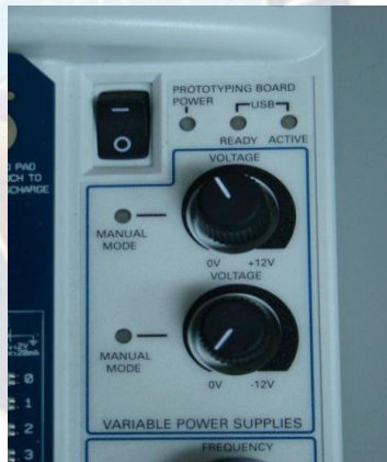
Figura 5.6.8: Control manual de la fuente de poder. Fuente: Tutoriales de NI (National Instrument) www.ni.com
