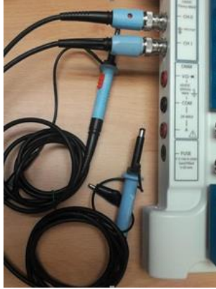
Figura 7.5.5: Conexiones de las puntas de prueba al NI ELVIS. Fuente: Elaboración propia
