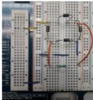
Figura 7.5.14: Rectificador de onda completa implementado en el NI ELVIS. Fuente: Elaboración propia
