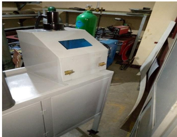
Fig. 3.17. Cámara de inspección de luz ultravioleta, fuente propia.
