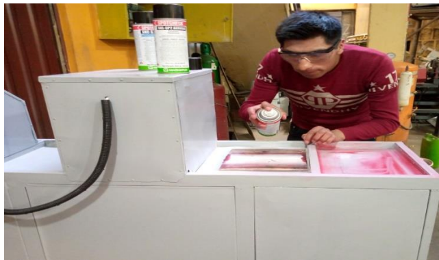
Fig. 3.14. Aplicando el revelador a la probeta de soldadura. Fuente propia.
