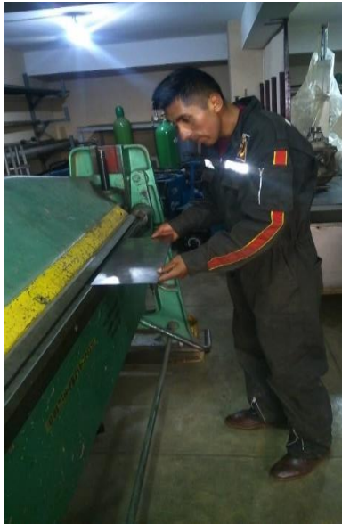
Fig. 3.5. Plegado de chapas utilizando el equipo plegador. Fuente propia.
