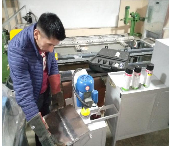
Fig. 3.9. Utilizando limpiador de probetas de soldadura.
