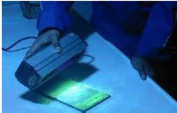
Figura 2.7. Presenta la forma en que se realiza la inspección para encontrar fallas.
