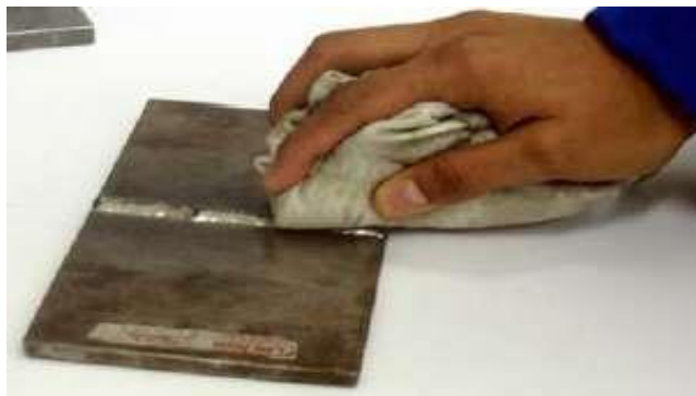
Figura 2.2. Se muestra la forma en que se realiza la limpieza de una pieza, ASTM Practice for L P Inspection M. Standard E-165
