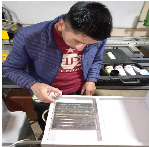
Fig. 3.10. Aplicacion liquido penetrante visible (aerosol) al probeta de soldadura.
