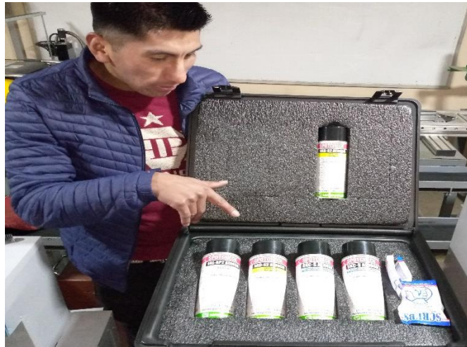
Fig. 3.2. Equipo portátil para la inspección, SPOTCHECK AWS 2644, ASTM E-165.
