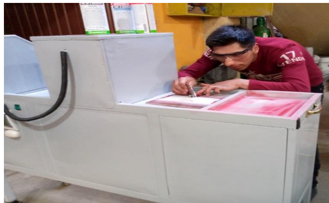
Fig. 3.15. Inspección de cordón de soldadura empleando instrumento de medición calibrador (gauge).
