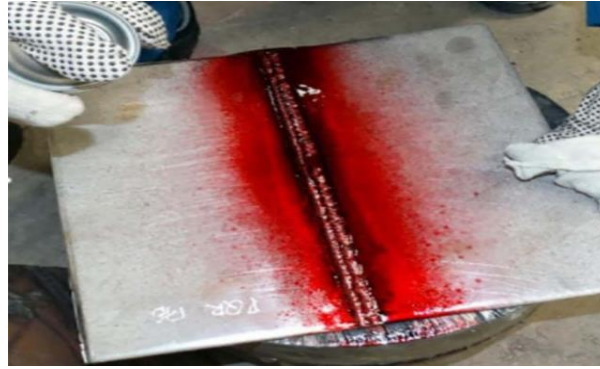
Figura 2.3. Muestra el momento en que se aplica Liquido Penetrante, ASTM E-165
