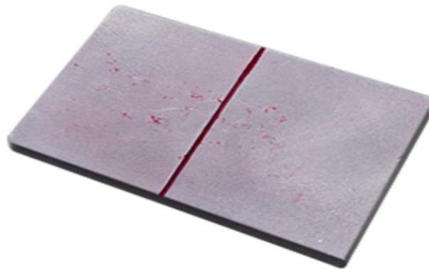
Fig. 3.21. Interpretación de bloque de comparación con penetrante. www.zion-ndt.mx .
