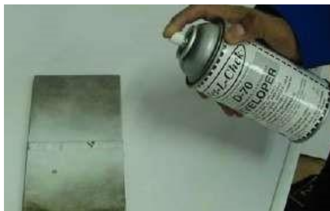
Figura 2.6. Se puede observar el momento en que se aplica el Revelador.
