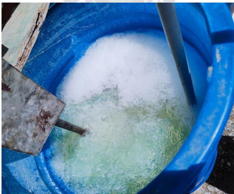
**Nota.** Fotografía del equipo en funcionamiento, se observa la turbulencia generada por la dosificación del CO<sub>2</sub> y la acción del agitador (se observa el agitador que no está dispuesto en el centro geométrico del tanque).
