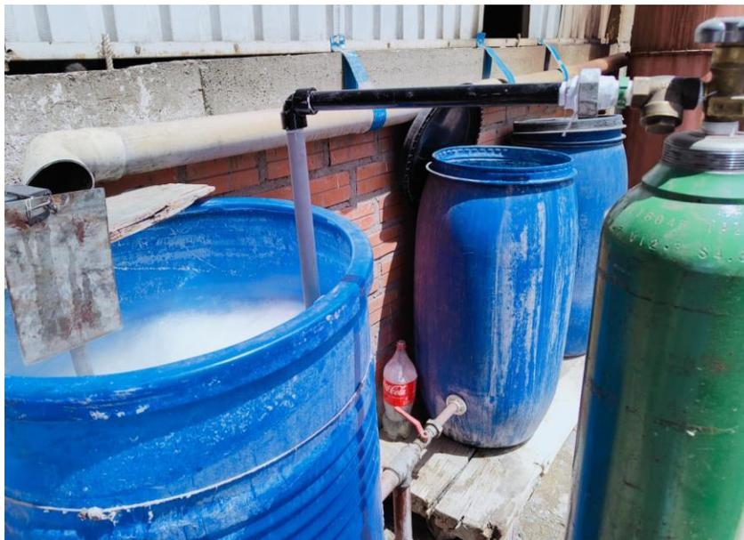
**Nota.** Fotografía del equipo implementado, se observa el botellón de CO<sub>2</sub> conectado al dispersor de gas, al otro extremo se observa el agitador conectado al motor.
