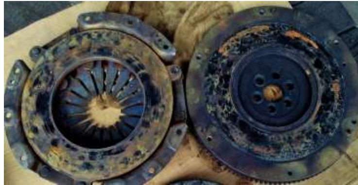
Figura 58. Desgaste de las pistas del plato prensa y volante de inercia
