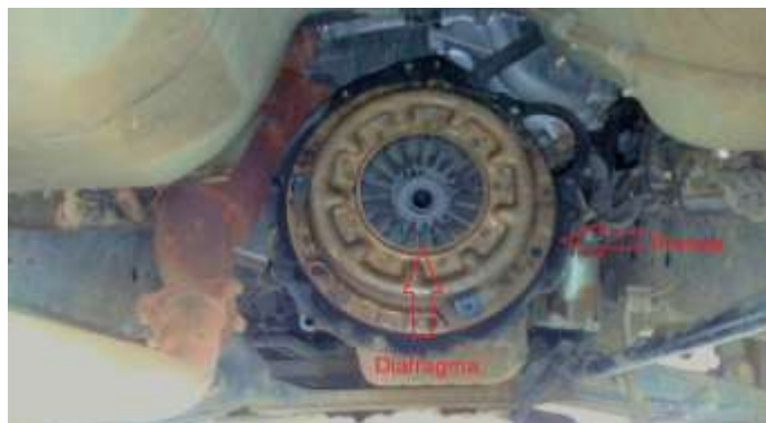
Figura 57. Prensa montada sobre el volante de inercia
