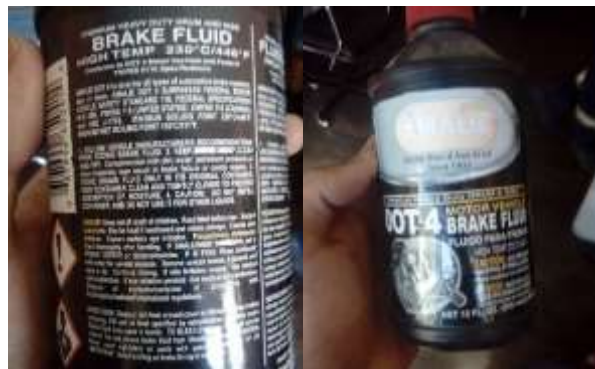
Figura 13. Líquido de freno DOT 4 utilizado en la tarea de mantenimiento
