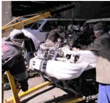
Figura 80. Extracción del motor del vehículo siniestrado
