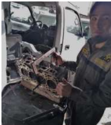
Figura 38. Desmontaje de las válvulas
