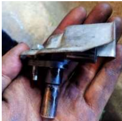
Figura 53. Sensor de giro desacoplado de la campana
