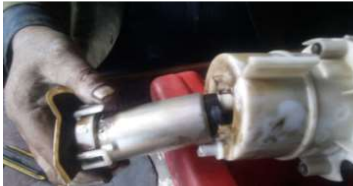
Figura 99. Bomba de combustible eléctrica sumergida
