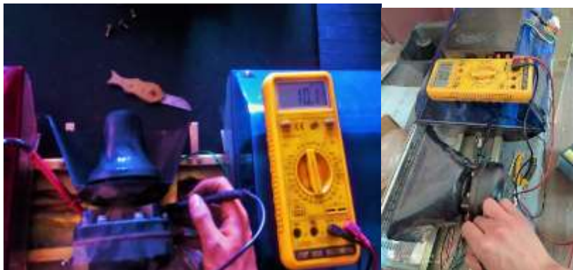
Figura 25. Medición de la resistencia de la bocina de la sirena
