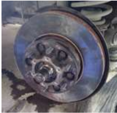
Figura 17. Inspección de disco de freno
