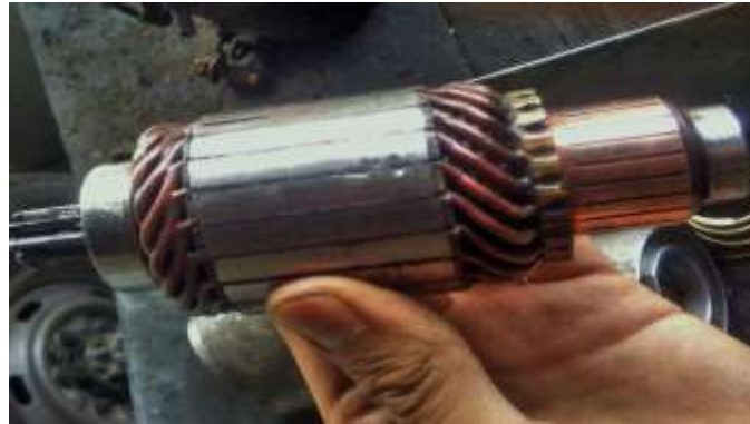
Figura 71. Inspección del rotor del motor de arranque (Toyota Land Cruiser)
