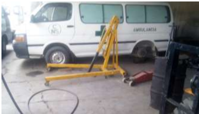
Figura 11. Pluma para motor del taller
