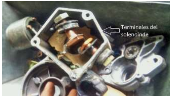
Figura 69. Terminales del solenoide (Toyota Land Cruiser)
