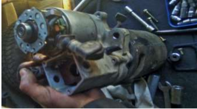
Figura 73. Montaje motor de arranque (Toyota Land Cruiser)
