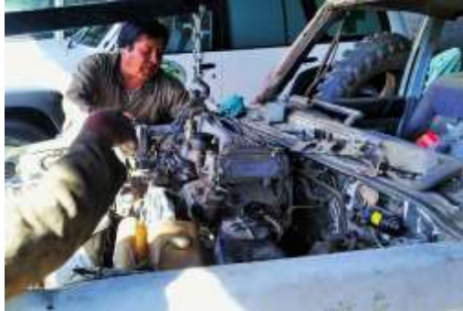
Figura 79. Proceso de elevación del motor con el tecla
