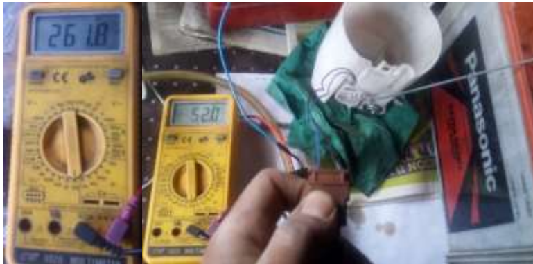
Figura 99. Valores de medición de la resistencia del sensor
