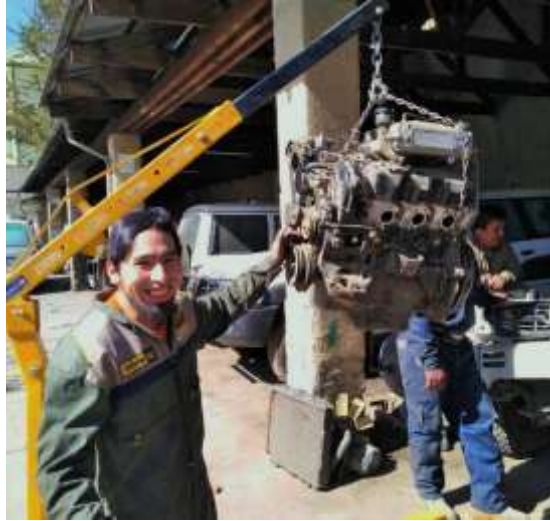
Figura 83. Motor elevado para su montaje
