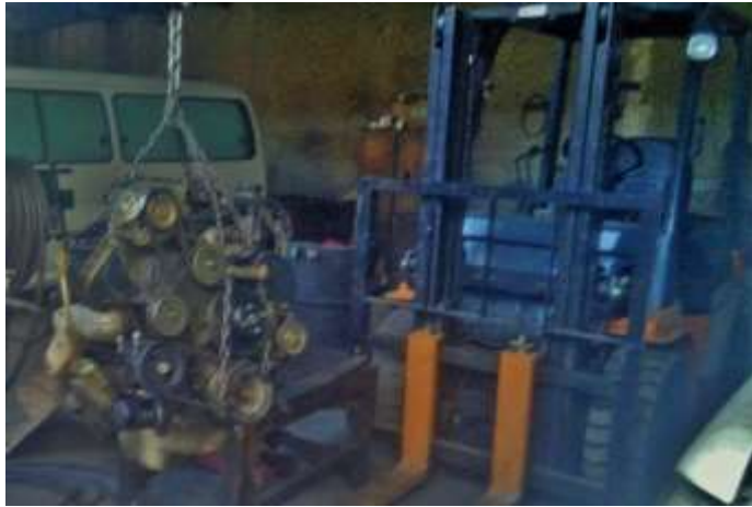
Figura 81. Posicionado del motor extraído en un lugar estable
