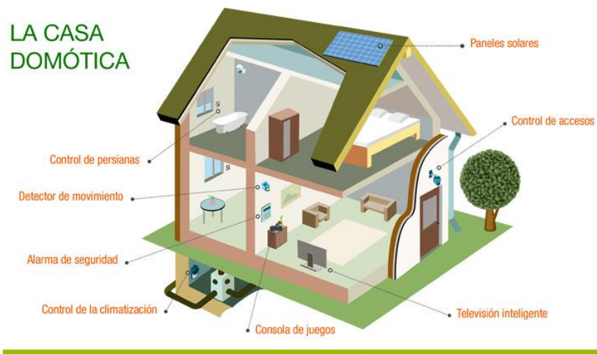
Figura 2.2. Funciones básicas en las instalaciones domóticas
