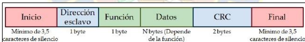
Figura 30. Trama de datos RTU
