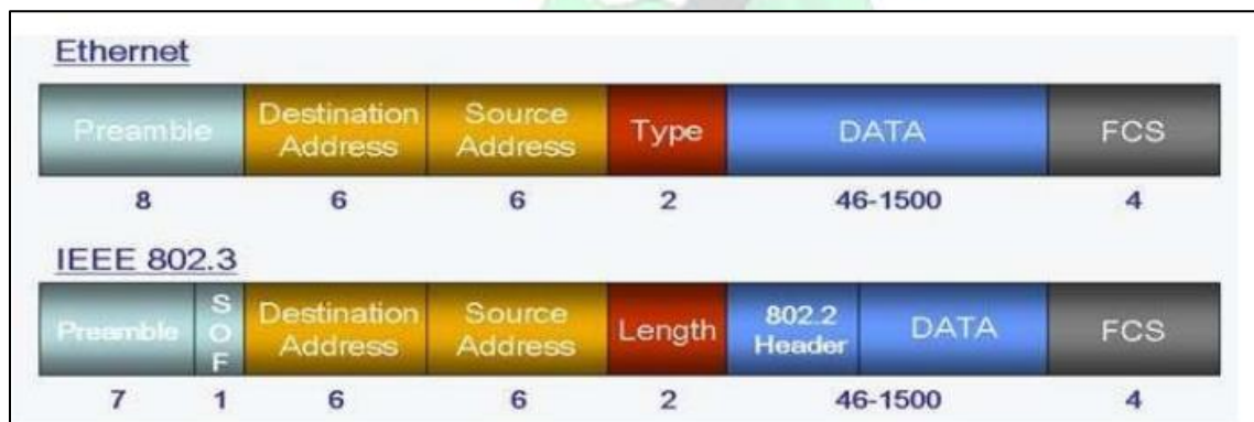
Figura 47. Comparativa trama Ethernet e IEEE 802.3
