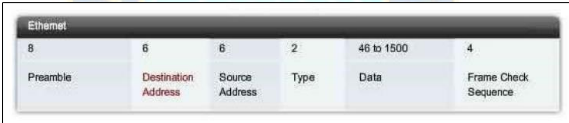
Figura 46. Trama de datos Ethernet
