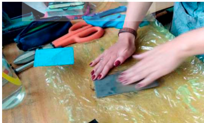
Figura 39. Lijado de la Superficie General de la Placa
